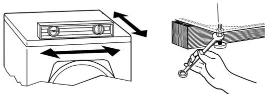
Si la laveuse est placée contre un mur, on doit l'écarter légèrement du mur avant de l'incliner vers l'arrière. Si la laveuse n'est pas d'aplomb, soulever l'avant de la laveuse avec une cale de bois et ajuster la position des pieds selon le besoin; soulever ensuite l'arrière de la laveuse et ajuster la longueur des pieds selon le besoin. Répéter ces opérations jusqu'à l'obtention d'un aplomb correct de la laveuse.
