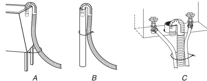
4. Si les robinets d'eau et le tuyau rigide de rejet à l'égout sont placés en retrait, introduire l'extrémité en crochet du tuyau de vidange dans le tuyau rigide de rejet à l'égout. Voir l'illustration C.
